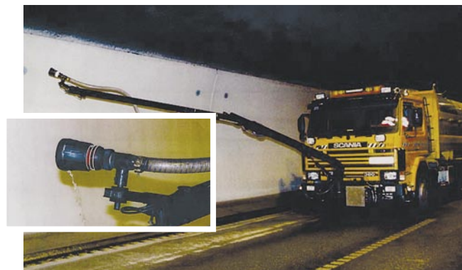
Nahaufnahme der Niederdruckdüse
