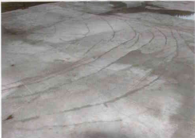
Fließgelenklinien an der Oberseite des Randfeldes
