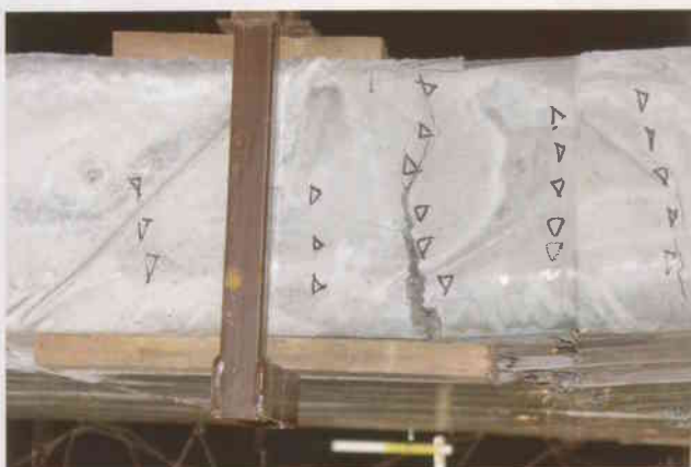
Bildung eines plastischen Gelenkes im SFB
