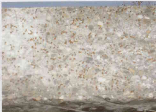
Gleichmäßige Faserverteilung in der Matrix
