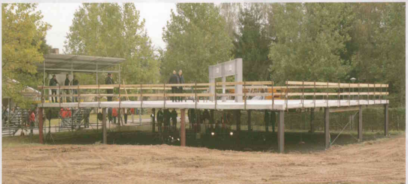
Testaufbau bei der Einzelbelastung in der Feldmitte
