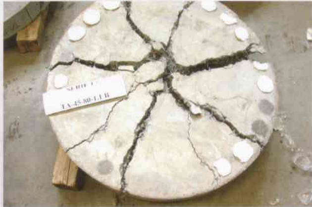
Platte nach der Prüfung
