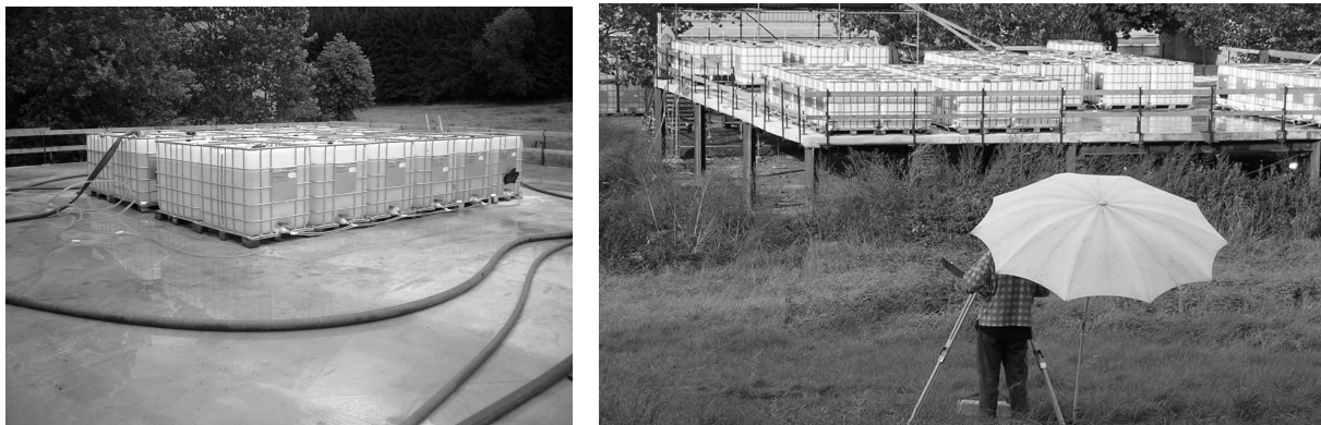
Bild 3: Wasserbehälter für Lastfall 1 (nahezu Vollfüllung) und 4 (beim Aufbau)
