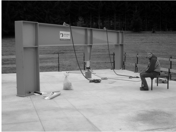
Bild 6: Belastungsrahmen und Rißbild Eckfeld
